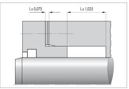
Fig. 54 DMS installation space example
