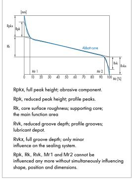
Fig. 32 Additional parameters
