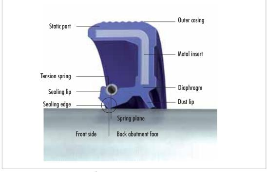
Fig. 1 Important parameters on a Simmerring®
